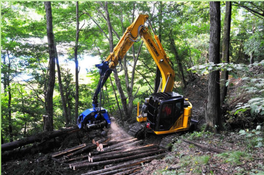
0,5m 3 後方小旋回 プロセッサ (GP-35V)
